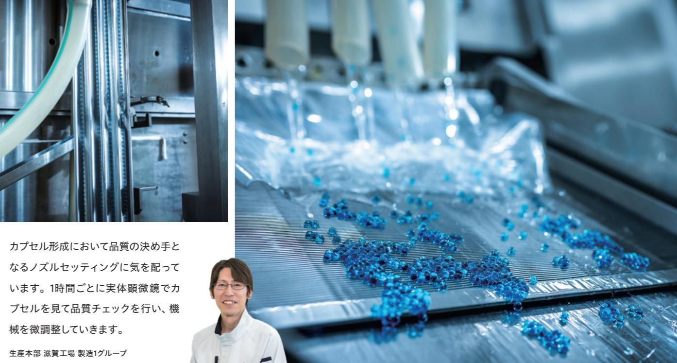
カプセル形成において品質の決め手となるノズルセッティングに気を配っています。1時間ごとに実体顕微鏡でカプセルを見て品質チェックを行い、機械を微調整していきます。
